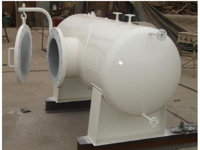
**OBRA:** "FABRICACION DE TANQUE DE GLP DE 200 GL"
